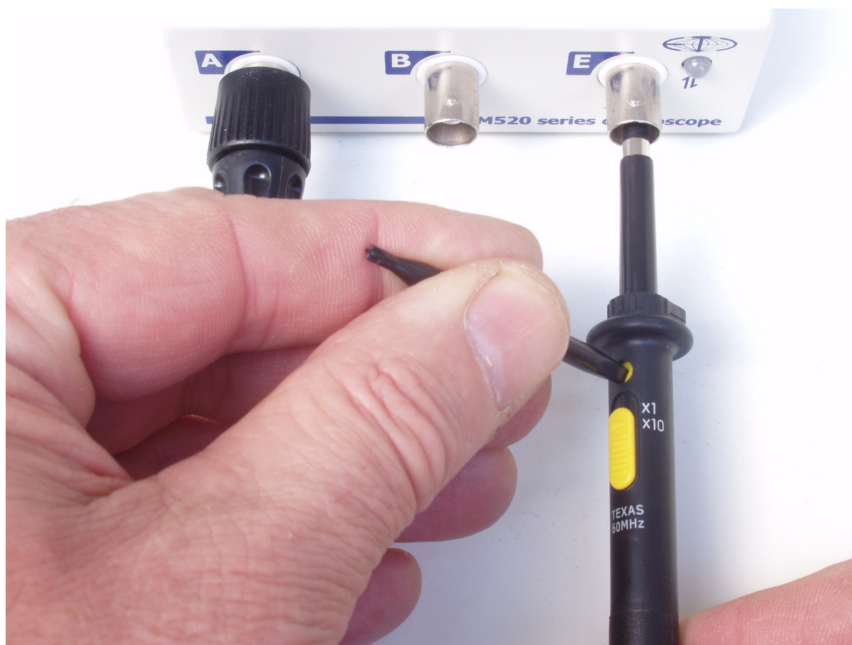
Obr. 2.1.1.1. Zapojenie pre kompenzáciu sondy ku kanálu A
